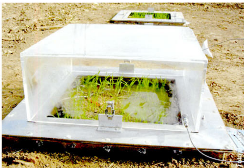
Hochempfindliche Systeme messen unter den Hauben das Treibhausgas in der Luft.
